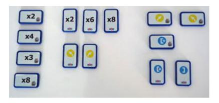
Mit einem Tac Tile Reader können bis zu 10 Befehle programmiert werden. Maximal drei Tac Tile Reader können miteinander verknüpft werden und bieten so die Chance, höchstens zu 30 Befehle einzugeben.
